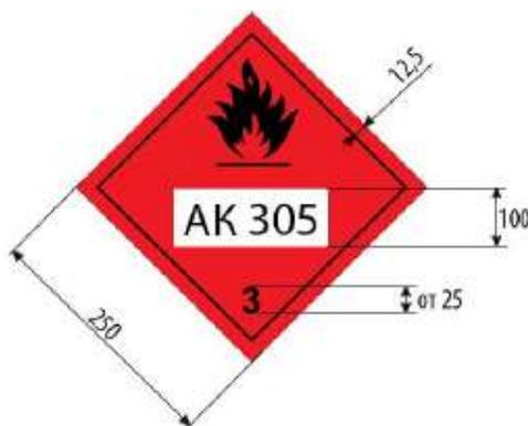
Рисунок 6 – Знак опасности при нанесении его на транспортное средство
