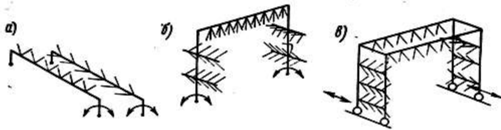
Рисунок 15.2 - Схема подвижных моечных устройств
